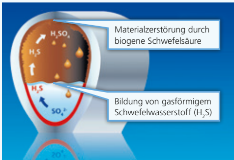
Abb. 2: Bildung von H 2 S und biogener Schwefelsäure
