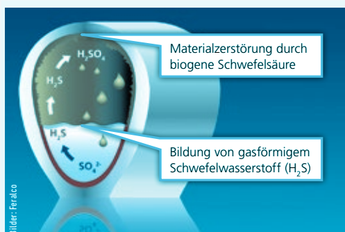
Abb. 2: Diagramm Entwicklung Sulfat, Sulfid, Nitrat, Nitrit
